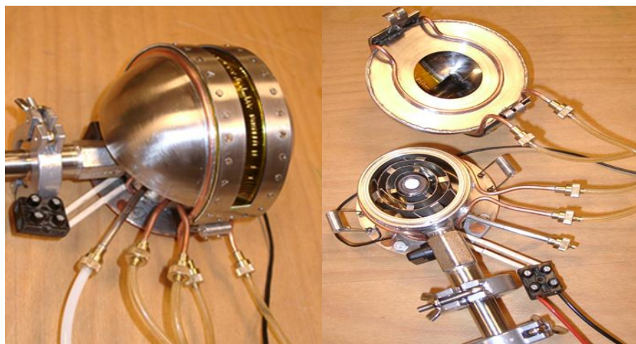
Фиг. 2.11 Вакуумна камера с нагревател оперираща в кислородна атмосфера при температури близки до 800°C, конструирана за работа на гониометър на синхротронно лъчение. Всички размерни единици са в “mm”.
